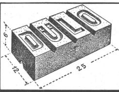
Nagelbar, schraubbar, volumenbeständig, binden mit dem Mörtel ab. Unterteilbar in  $^1/_8$ ,  $^1/_4$ ,  $^1/_2$  und  $^3/_4$  Steine. Säurenfrei. Beste Befestigungs-Hinterlage für Schreinerarbeiten. Speziell zum Versetzen im Eisenbeton für die Befestigung von Lattenrosten, Rohrleitungen etc.
