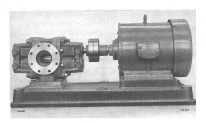
Maag-Zahnradpumpe in rostfreier Ausführung mit Aussenlagern zur Förderung von Fettsäure In Seifenfabrik. Druck 15 at.
