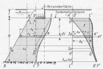
Abb. 8. Graphische Setzungsanalyse
