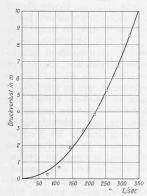
Abb. 3. Verlauf der Druckverluste in der Druckleitung
