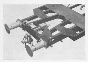
Abb. 5. Einbau der Zug- und Stossvorrichtung
