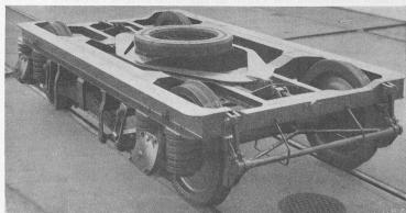
Abb. 6. Drehgestell der neuen AB4ū-Wagen der SBB, Bauart S. I. G. Neuhausen
