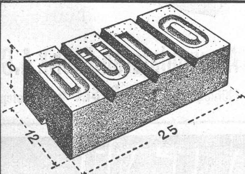
Nagelbar, schraubar, volumenbeständig, binden mit dem Mörtel ab. Unterteilbar in  $\frac{1}{8}$ ,  $\frac{1}{4}$ ,  $\frac{1}{2}$  und  $\frac{3}{4}$  Steine. Säurenfrei. Beste Befestigungs-Hinterlage für Schreinerarbeiten. Speziell zum Versetzen im Eisenbeton für die Befestigung von Lattenrosten, Rohrleitungen etc.
