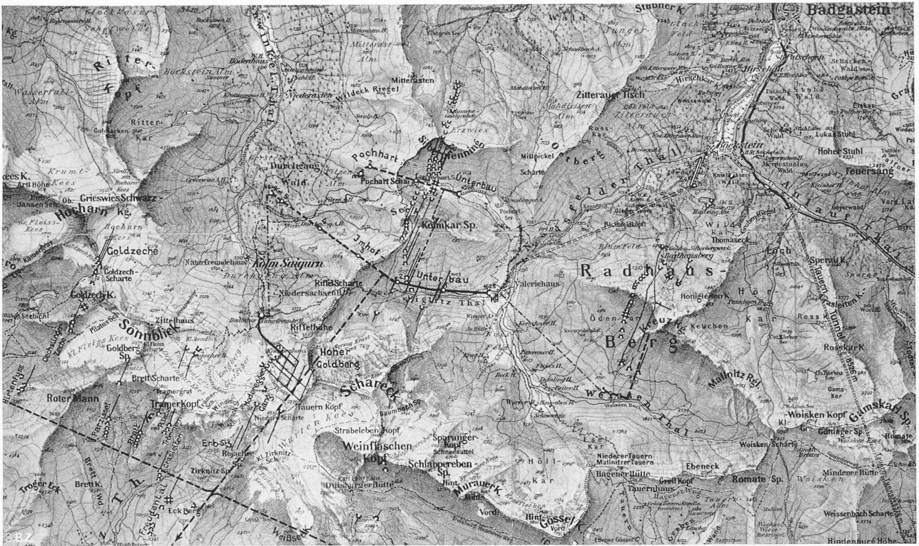
Abb. 5. Uebersichtskarte des Goldbergbau-Gebietes in den Hohen Tauern, mit Aufschliessungsprojekt von Oberbergat Dr. Ing. K. Imhof. — 1 : 100000 Starke Linien: voll ausgeführte, gestrichelt projektierte Hauptförder- und Verbindungstrecken; feine Linien: alte Stollen mit Mundlöchern; Doppelstrich: gestrichelt Förderwasserstollen; desgl. voll Bremsberg neben Druckleitung des Kraftwerks Böckstein; strichpunkt. proj. Seilbahnen
