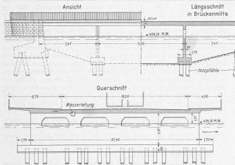
Abb. 3. Neue Brücke über den Schanzengraben in Zürich. 1:300
