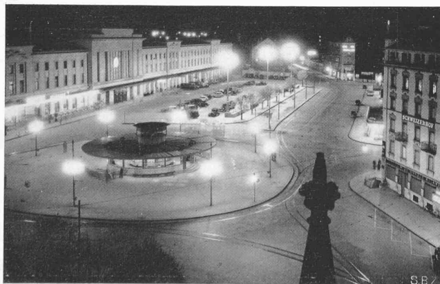
Abb. 1 (links) Der neue Bahnhofplatz Genf-Cornavin (ebenfalls mit runder Warthalle) beleuchtet mit Philips- «Philora»-Quecksilber- dampflampen H O 2000, gemischt mit 1500 Watt- Glühlampen
