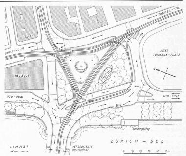
Abb. 1. Lageplan des umgebauten Bellevue-Platzes in Zürich. — 1:2000
