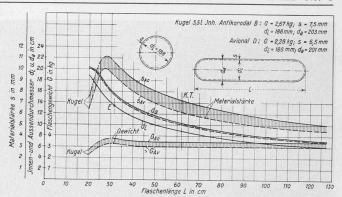
Abb. 6. Graphische Darstellung der Gewichte und Grössen einer  $3^{1}/_{2}$  1 Leichtmetall-Flasche. -- = Avional D. Die mit = Anticorodal B. - -K. T. bezeichnete Stelle entspricht der Armeeflasche, die mit E bezeichnete der entsprechenden englischen Ausführung
