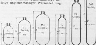
Abb. 4. Bauart der englischen Stahlflaschen (Cr Ni Mo-Stahl «Vibrac»)
