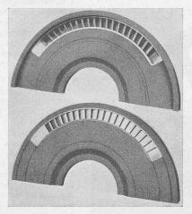
Abb. 4. Hochdruck-Leitschaufel-Düsen
