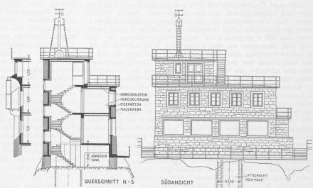
Abb. 17. Schnitte und Südfassade des Sphinx-Pavillon. — Masstab 1:250
