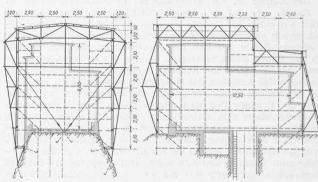
Abb. 16. Grundrisse. Masstab 1:250 Abb. 15. Zugang unten Schwarz Eisenbeton, kreuzschraffiert Mauerwerk, schraffiert Beton
