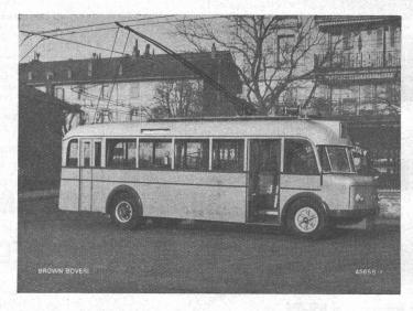
Trolleybus der Strassenbahn Lausanne mit Stromrückgewinnungs-Bremse
