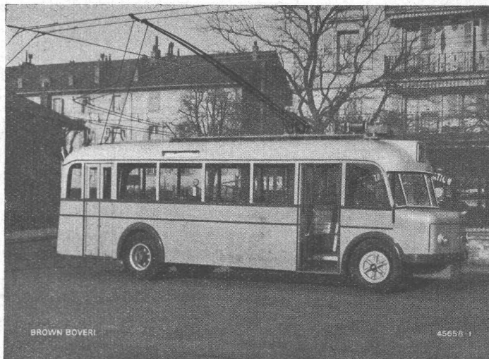
Trolleybus der Strassenbahn Lausanne mit Stromrückgewinnungs-Bremse
