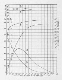
Fig. 17. Lentille C en régime de contrepression égale au vide : Coeff. caract, en fonction de l'inclinaison a de la lentille. kp = courbe 1 Hp = courbe 4 (neg.) kc = courbe 2 Hc = courbe 5 (neg.) kq = courbe 3  $Hq = -9.75 \, \text{m (neg.)}$  Inclination  $\delta$  de l'angle de la pousseé = courbe 6
