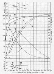
Fig. 15. Lentille A Fig. 16. Lentille B en régime de contre-pression nulle ou égale au vide : Coefficients caractéristiques en fonction de l'inclinaison  $\alpha$  de la lentille
