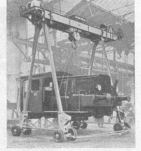
Mittelschwere Type, bis 30 t Tragfähigkeit
