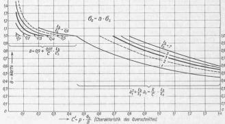
Abb. 3. Berechnung der Eisenspannungen bei gegebenen Materialcharakteristiken
