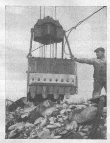
Verwendung von Stahlseilen in Greifbaggern
