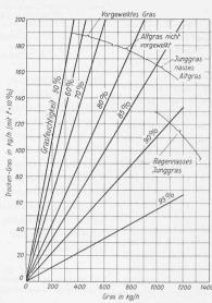
Abb. 1. Trockengrasertrag in Funktion der Grasmenge und Grasfeuchtigkeit
