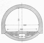
Abb. 3. Tunnelprofil 1:300 der Autocamionale Genua-Serravalle
