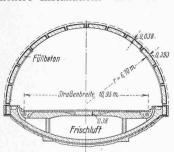
Abb. 8. Halbquerlüftung im Rampen-Profil des Mersey-Tunnels. - 1:300
