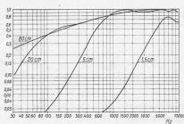
Abb. 2. Berechneter Schallschluckgrad von Filz
