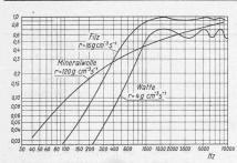
Abb. 1. Berechneter Schallschluckgrad poröser Materialien
