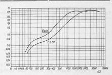
Abb. 3. Schallschluckgrad von Akustik-Perfecta-Platten
