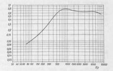
Abb. 10. Schallschluckgrad von Acousti-Celotex BBB
