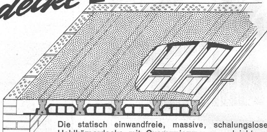
Die statisch einwandfreie, massive, schalungslose Hohlkörperdecke mit Querarmierung . . . leicht zu versetzen . . . kürzeste Bauzeit . . . tadellose Isolierung.
