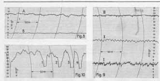
Dr. Frenzel-Diagramme: Abb. 10 (Fig. 8) A Flachsgarn, B Baumwollgarn,  $^{3}l_{4}\,^{0}l_{0}$  Gesamtdehnung. - Abb. 11 (Fig. 9) I Wollstreichgarn, II Baumwollgarn (Wellen wegen Ringbankspielen), III Viscosegarn, je bei 70  $^{0}l_{0}$  der Bruchdehnung (Viscose als Kunstprodukt sehr gleichmässig). - Abb. 12 (Fig. 10) Schlechtes Baumwollgarn,  $^{4}l_{2}\,^{0}l_{0}$  Gesamtdehnung (1 bis 4 Fadenbrüche)
