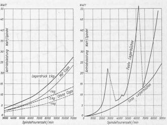
Abb. 17. Leistungsbedarf einer 9" Gleitlager-Spindel
