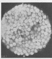
Abb. 9. Faserquerschnitte: a Schafwolle Vergrösserung 85 fach
