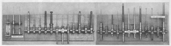
Abb. 20. Kollektion von Ringspindeln aus der Sammlung von Textilmaschinenteilen
