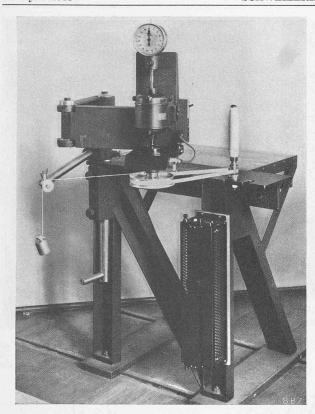
Abb. 16. Spindelprüfstand, mit stroboskop. Torsions-Ablesung
