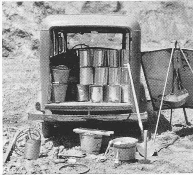
Abb. 16. Materialprüfungswagen mit Geräten
