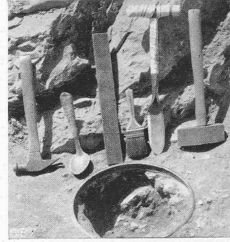
Abb. 17. Probelloch und zugehörige Werkzeuge
