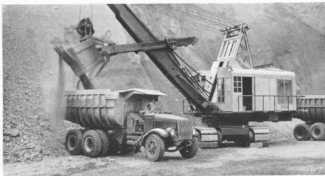
Abb. 7. 19 1/2 m³-Lastwagen, beladen durch 3 m³ Diesel-Schaufel
