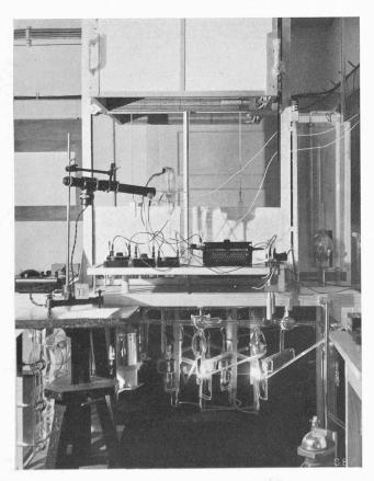
Abb. 5. Pumpgabelgestell für Bearbeitung verschiedenartiger Röhren
