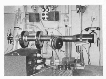
Abb. 6. Elektronenmikroskop zur Untersuchung v. Kathoden-Materialien
