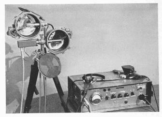
Abb. 9. Sende- und Empfangsgerät für Lichttelephonie
