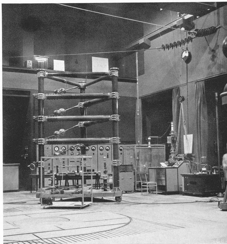
Abb. 2. Neues Hochspannungs-Laboratorium, mit Versuchsaufbau zur Demonstration des Eindringens von Wanderwellen in Wicklungen; rechts Kathod. Oszillograph
