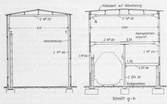
Abb. 13. M. S. Z., links Querschnitt der alten Montagehalle, rechts Wiederverwendung für das Metallspritzwerk unter gleichzeitiger Verbreiterung durch Einsetzen der Stücke A. — Masstab 1:250
