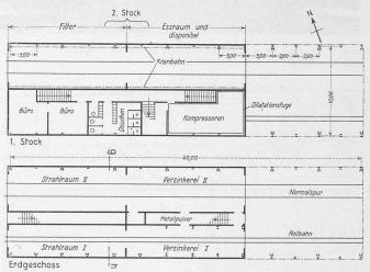
Abb. 10. Metallspritzwerk. Grundrisse 1:400
