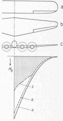
Abb. 1. Einfluss der Flügelgrundrissform und dezentralisierter Massenverteilung auf die Biegemomente MB am Flügel.
