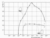
Abb. 3. Autorotations-Drehzahlen u/Vin Abhängigkeit vom Anstellwinkel a
