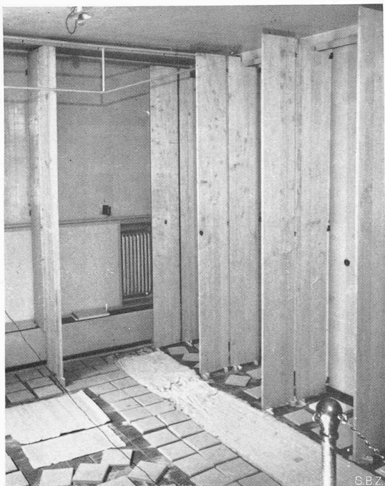
Abb. 4. Vertikale Vollmasstab-Holz-kassetten im Hallraum
