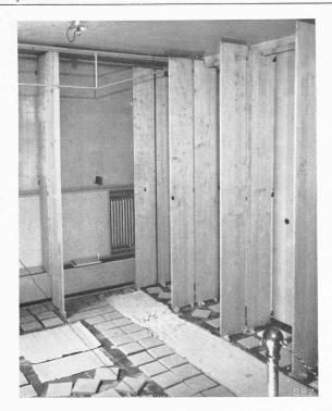
Abb. 4. Vertikale Vollmasstab-Holzkassetten im Hallraum
