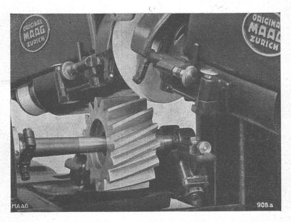
MAAG-ZAHNRADSCHLEIFMASCHINE für Stirn- und Schraubenverzahnungen Schleifgenauigkeit bis 0,002 mm.
