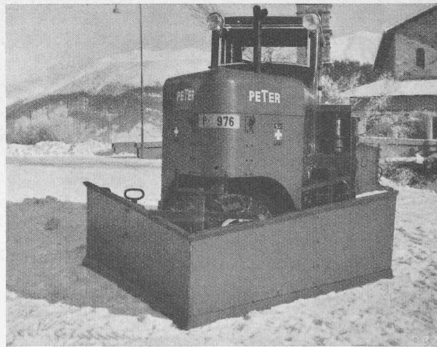
Abb. 4. Schneeschleuder mit rückwärts angehängtem Stosspflug.
