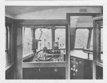
Abb. 7. Führerraum mit Führertisch (Phot. Oerlikon) 1 Volt- und Ampèremeter für Fahrdraht und Triebmotoren; 2 Fahrplanhalter; 3 Handrad des Steuerkontrollers; 4 Summer der Sicherheitssteuerung; 5 Manometer; 6 Abfahrtsignallampe; 7 Signallampe der automat. Zugsicherung; 8 Geschwindigkeitsmesser; 9 Führerbremsventil; 10 Steuerschaltkasten; 11 Schalttafel für Beleuchtung und Führerraumheizung
