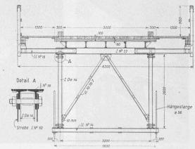
Abb. 2 und 3. Ansicht und Querschnitt der eisernen Notbrücke. - Masstab 1:85
