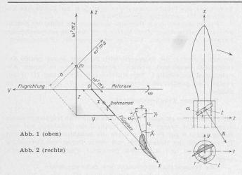
lung» mit dem der Motoraxe zugehörigen Koordinatenkreuz  $x,\ y,\ z$  zusammen. In dieser, etwa durch den Winkel  $\beta_r$  (Abb. 1) gekennzeichneten Stellung übt das Zentrifugalfeld auf den Flügel nach dem Gesagten ein Moment  $M_0$  aus, das den verkleinerten Stellungswinkel  $\beta_r$  zu verringern trachtet:
