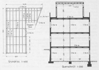
pappe frei aufgehängt ist; selbst kräftiges Klavierspiel wird in der Nebenwohnung nicht gehört. Die Stahlsäulen sind mit Celotexplatten belegt und mit einem in Gips getauchten Jutestreifen bandagiert. Zwischenwände und Säulen sind somit konstruktiv getrennt, ebenso die Zwischenwände von den Böden durch eingelegte Korkstreifen.
