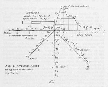
Vom Lotpunkt unter der Geschützmündung sind nach verschiedenen Richtungen Messtrecken gelegt mit darauf verteilten Druckdosen. Abb. 2 zeigt die Anordnung für ein horizontal feuerndes 12" (305 mm) Küstengeschütz; die Maximaldrucke sind graphisch über den Strecken aufgetragen. Für andere Kaliber ergaben sich ganz ähnliche Druckverteilungen; immer ist das Maximum beim 45° Abwärtspunkt von der Mündung. Es wurde in zahlreichen Wiederholungen gefunden:
