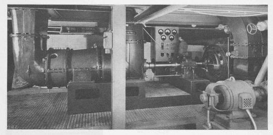
Abb. 33. Die Luftturbinengruppe im Untergeschoss: links die Turbine, rechts Dynamometer und Bremsgenerator, rechts vorn Motor der Vakuumpumpengruppe des Ueberschallkanals
