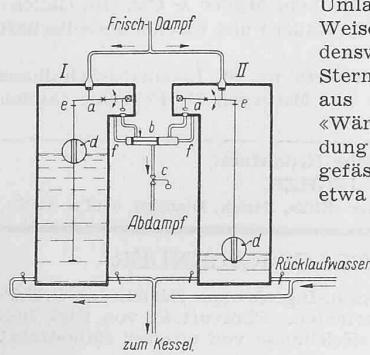
a Ventilhebel, b Umsteuerapparat, c Überströmventil, d Schwimmer, e Anschlag, f Steuerleitung.
