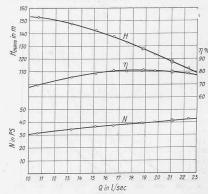
Abb. 7. Versuchskennlinie einer «Müller»-Kleinpumpe für 18 l/sec, 9-stufige Leitradpumpe H. Z. P. 15  $n=1460,\ n_8=96.$
