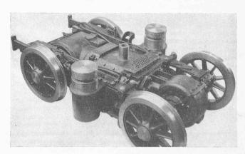
Abb. 2. Das «Simplex-Drehgestell» des Wagens für Meterspur
