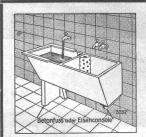
Wasch- und Einweichtröge in dünnwandigem Eisenbeton
