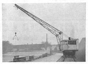
Fahrbarer Dieselmotor-Drehkran auf Normalspurgeleise
