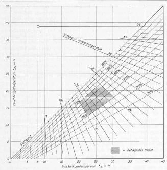
Abb. 2. Psychronometrische Behaglichkeitstafel; m=F ( $t_{Tr},t_k$ )
