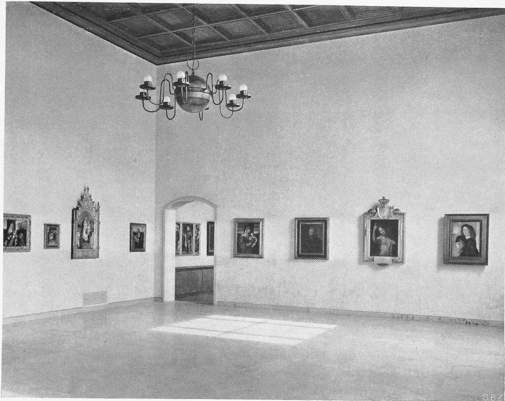
Abb. 9. Italiener-Seitenlichtsaal (Durchblick zur Bachofensammlung) im I. Obergeschoss. Decke dunkelgebeiztes Tannenholz. Wände naturfarbener Leinensamt, Türeinfassungen, Sockel und Bodenbelag heller Solothurner Kalk, geschliffen.
