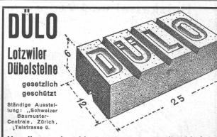
Nagelbar, schraubbar, volumenbeständig, binden mit dem Mörtel ab. Unterteilbar in  $^1/_4$ ,  $^1/_2$  und  $^3/_4$  Steine. Säurenfrei. Schweiz. Drahtziegelfabrik A.-G., Lotzwil.
