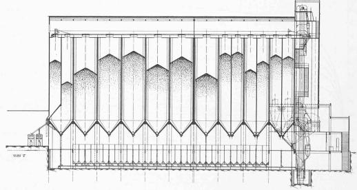
Abb. 2. Längsschnitt durch die Siloanlage, rd. 1:550
