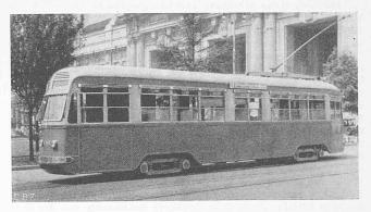
Abb. 1. «Stromlinienartiger» Wagen der Mailänder Strassenbahn
