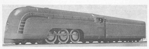
Abb. 2. Stromlinienförmig umgebaute «Mercury» K5 Pacific Lokomotive der N. Y. C.-Rd.
