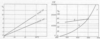
Abb. 7 (links). Zunahme des Wärmeverbrauches mit steigender Kühlwassertemperatur
