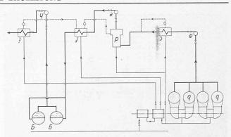
Abb. 3. Schema der Speisewasser-Vorwärmung
