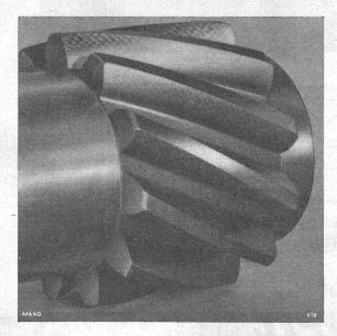
Auf MAAG - Zahnradschlelfmaschine geschliffenes Schraubenritzel. (Man beachte den Kreuzschliff).
