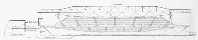
Abb. 5. Längsschnitt 1:800 mit den auf vier Säulen ruhenden Längsträgern von 90 m Stützweite. Querträger Q=60 m lang
