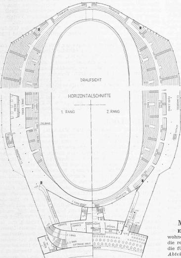
Abb. 3. Grundriss vom 1. und 2. Rang mit Draufsicht. — 1:1000
