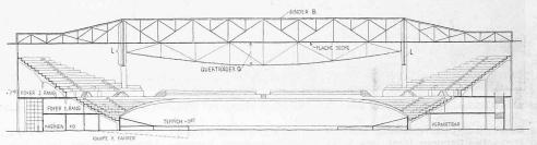
Querschnitt des Hallenstadions in der Queraxe. - Masstab 1:800
